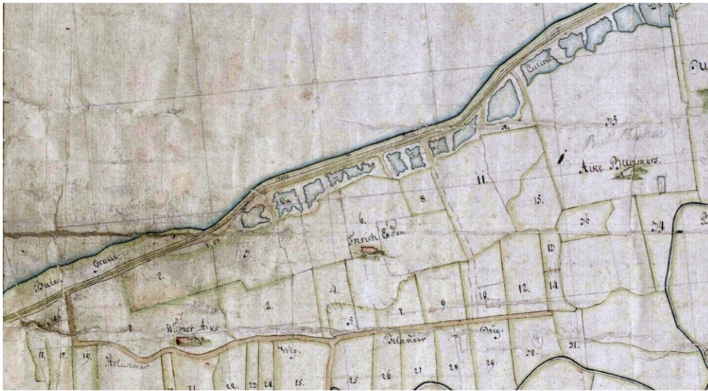
Abb. Deichschutz vor Kleinholum: Wo Butengroden vorhanden war, reichten Strohdämme, wo Saarteiche auf wenig Schutz hinweisen, überwiegen die kostspieligen Holzdeiche. (StAAu Rep 244 C 2816) 14
